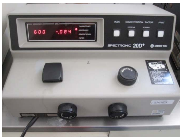
Figura 14 espectrofotómetros SPECTRONIC 20D+ (Milton Roy) en donde se mide la absorbancia con un filtro entre 600 y 950nm.
