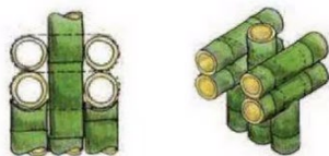
Dos vigas laterales dobles
