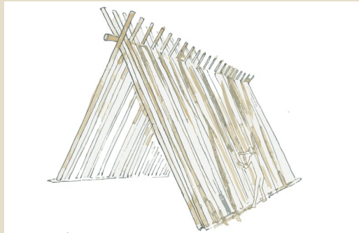
Bambú apilado verticalmente para secado | Lucila Aguilar Arquitectos
