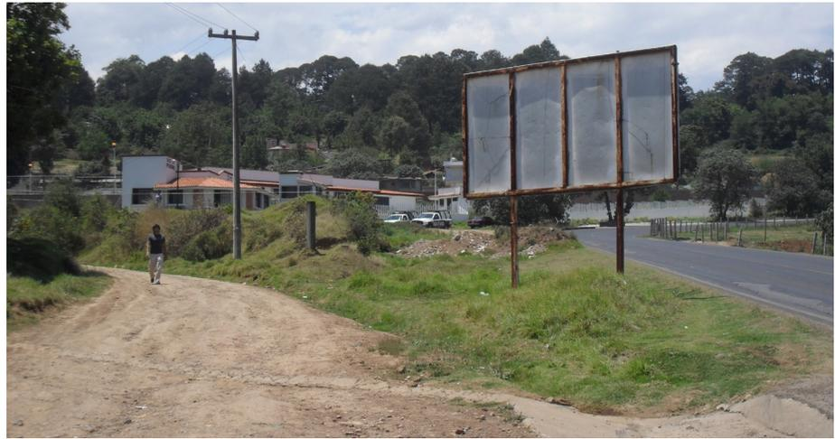
El terreno en la Delegación de Zacatlán, la cual es un ejemplo de delegación media, era muy irregular de forma y topografía. Esto aumentó los costos de construcción, ya que se tuvo que allanar el terreno y levantar muros de contención. ▲
