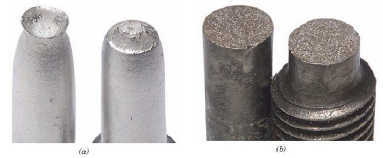
21 Tipo de falla dúctil (o maleable)(a) y falla frágil (b). Materials Science and Engineering.
