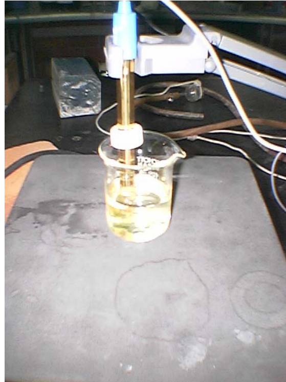
Figura 5-22 Apariencia con 300 ppm de Coagulante de la Primera Concentración de Cadmio a pH Óptimo.
