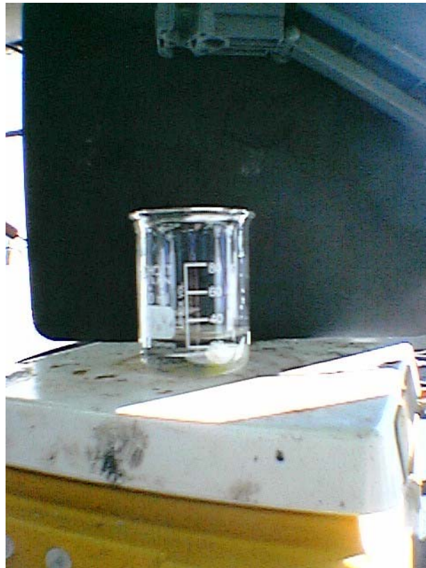
Figura 5-6 Apariencia con 11 Microlitros de NaOH 8N de la Primera Concentración de Cadmio.
