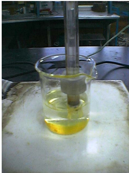
Figura 5-13 Apariencia con 50 Microlitros de NaOH Saturada de la Segunda Concentración de Cadmio.
