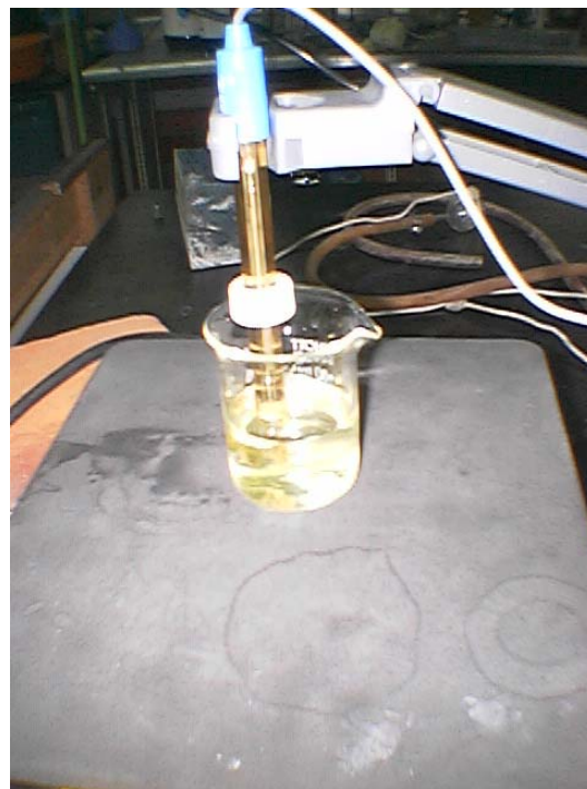
Figura 5-19 Apariencia con 150 ppm de Coagulante de la Primera Concentración de Cadmio a pH Óptimo.
