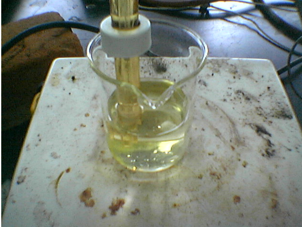
Figura 5-7 Apariencia con 12 Microlitros de NaOH 8N de la Primera Concentración de Cadmio.
