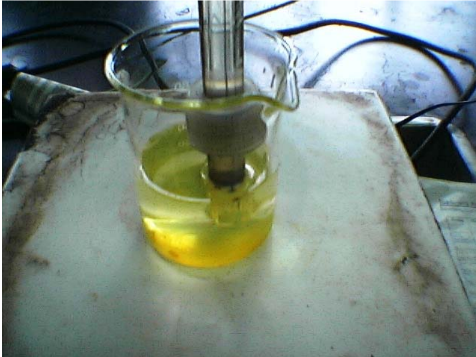
Figura 5-10 Apariencia con 20 Microlitros de NaOH Saturada de la Segunda Concentración de Cadmio.
