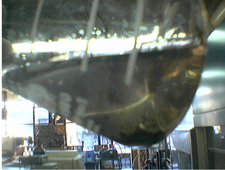
Figura 4-8 Tratamiento de Agua Residual con Plomo con Concentración de 20. 548 ppm.
