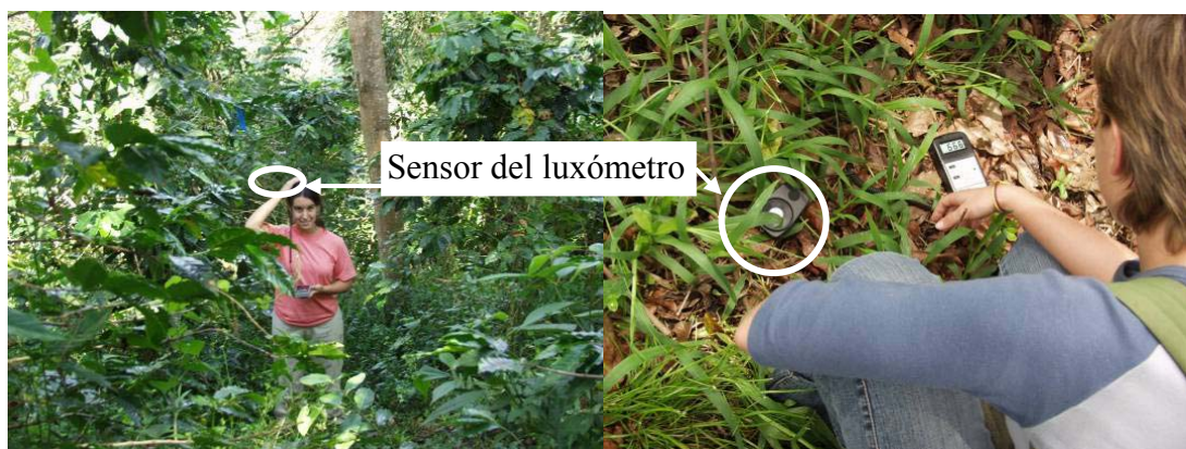
Figura 4.6 Medición de la intensidad luminosa (Derecha: a 1.60 metros sobre el suelo, Izquierda: al nivel del suelo).
