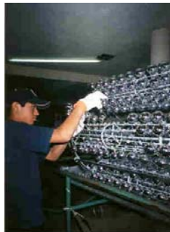
RETIRO DE ESFERA METALIZADA
