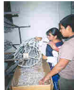
COLOCACIÓN PREVIA AL METALIZADO
