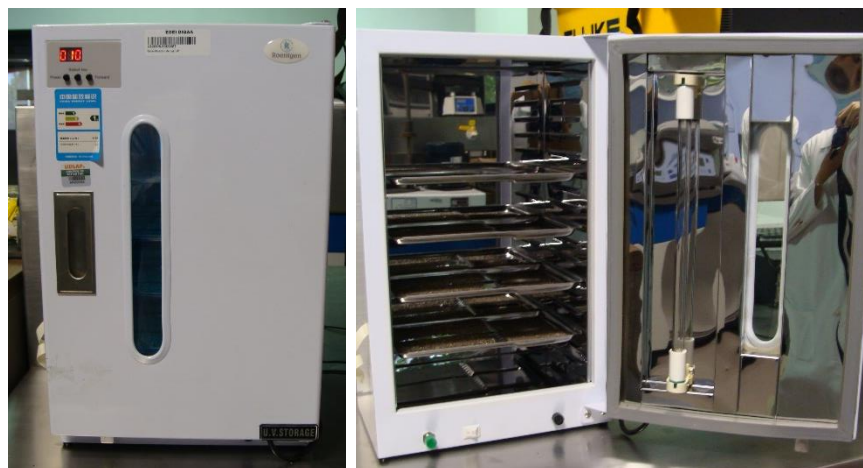
Figura 1. Cámara para tratamientos con luz UVC. Vista exterior (izquierda) e interior (derecha)
