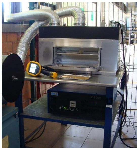
Figura 2. Equipo SteriPulse PL Z-1000 modelo LH-840 donde se realizaron los experimentos de PLAI.
