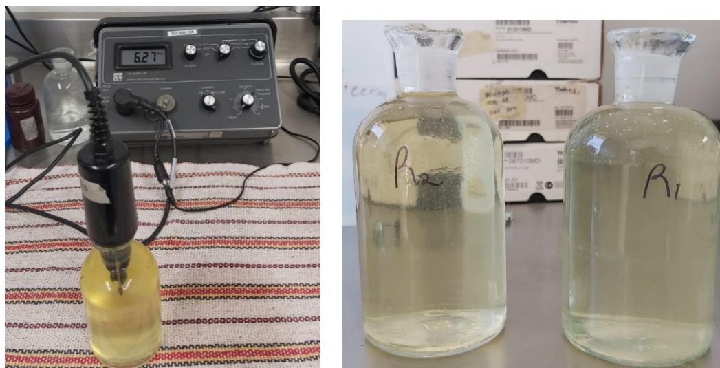
Figura 11. Estrategia de medición de OD en los SBRs
