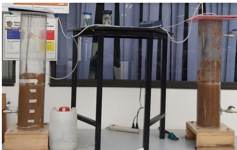
Figura 10. Unidades experimentales (SBR) para el desarrollo de la granulación aerobia.
